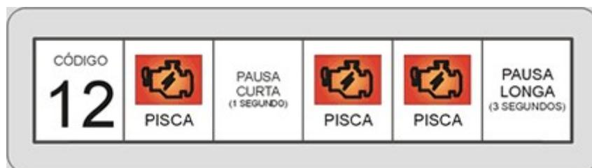
Cada erro armazenado vai repetir-se por 3 vezes e passar para o próximo código de erro. O código 12 não é erro, indica o inicio de diagnóstico e o código 31 sempre vai acusar se você fizer o teste com o motor desligado.
